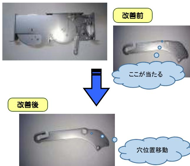
改善後 作動レバ-の穴位置をR部に近づけるように金型改造を行い、歯車との距離を調整。組み直し作業や作動レバ-の手直しが削減手直し、組み直し削減=1,750分/年削減
