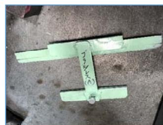
左の写真、部品Aの端面から部品Bの端面までの巾を12mmにする寸法だしの治具が右の写真。
