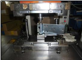
金型をQDC化して（油圧プレスに変更）
