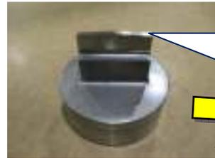
追抜き型を研磨する時研磨機のマグネット台を傾斜させて研磨しているが段取りが面倒だった…又、台を元の水平に戻すのも面倒だった。
