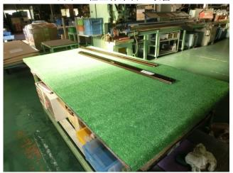
●キズがNGの製品が多いアルミ工場では作業台の上に人工芝を貼り、具合を試してます。今後はどのタイプの人工芝がいいか色々試してみて、他の作業台にも水平展開してみる。(内装部品業界の工場見学により得た知識を真似た)
