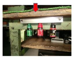
●形材に穴をあけキャップを埋め込んだケースを机に設置 これで引き出しを開けてキャップを外すムダが無くなった
